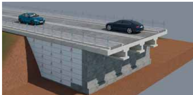
Слика 2 Спречување на населување во конструкции за пристап до мост и полнење на падини на мека почва.
