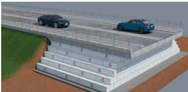
Слика 1 Начин, кој се користи за замена на полнење со земја, кај автопати, мостови и рампи при што го олеснува оптоварувањето на дизајнот.
